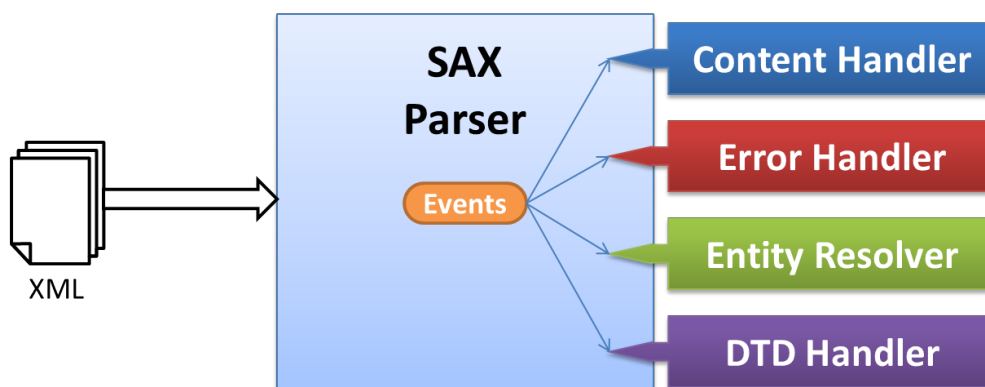
Rysunek 17. Schemat SAX parsera
